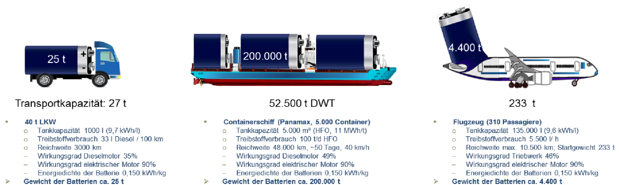
Abbildung 1: Grenzen der Elektrifizierung des Transportsektors (Schwerlast und Fernverkehr) durch die geringe gewichtsbezogene Energiespeicherdichte von Batterien (DWT: Deadweight tonnage, DWT ist die Summe des Gewichts aus Fracht, Treibstoff, Frischwasser, Ballastwasser, Vorräten, Passagieren und Crew).
